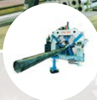
Установки автоматической продольной сварки опор
