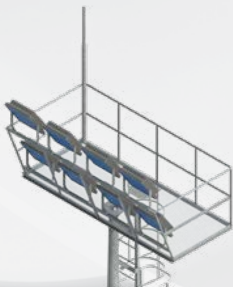
Тип ПРП8 Мачты с прямоугольной площадкой и лестницей для доступа персонала. Условно предполагается размещение 8 осветительных приборов, но в зависимости от наветренной площади и габаритов количество может быть изменено.
